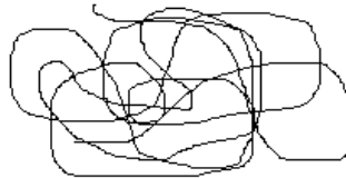
Fig.4. Structure amorphe d'un polymère
