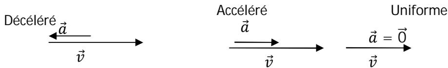
**Figure II.18 :** Vecteurs vitesse et accélération dans le cas d'un mouvement **rectiligne**.
