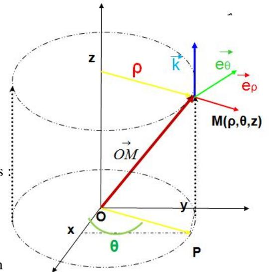
Figure II.4 : Les coordonnées cylindriques  $(\rho, \theta, z)$  et la base associée  $(\vec{e}_\rho, \vec{e}_\theta, \vec{k})$
