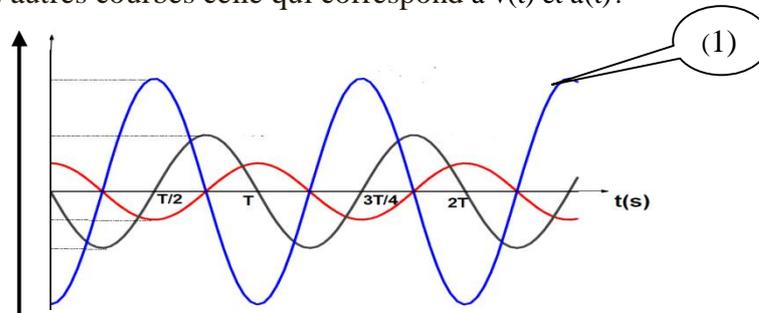
Diagrammes du mouvement rectiligne sinusoïdale.
