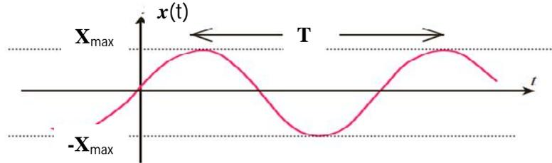
**Figure II.10 :** Représentation du mouvement sinusoïdal dans le temps.
