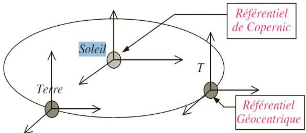
**Figure II.1** Les référentiels de Copernic et géocentrique : le référentiel géocentrique est en mouvement circulaire uniforme par rapport au référentiel de Copernic.
