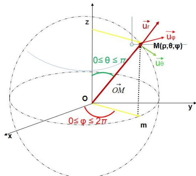
Figure II.5 : Les coordonnées sphériques  $(r, \theta, \varphi)$  et la base associée  $(\vec{u}_r, \vec{u}_\theta, \vec{u}_\varphi)$ .
